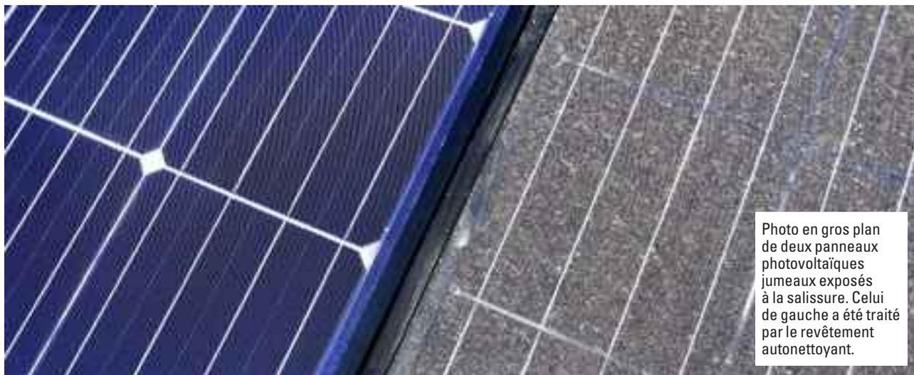
Photo en gros plan de deux panneaux photovoltaïques jumeaux exposés à la salissure. Celui de gauche a été traité par le revêtement autonettoyant.
